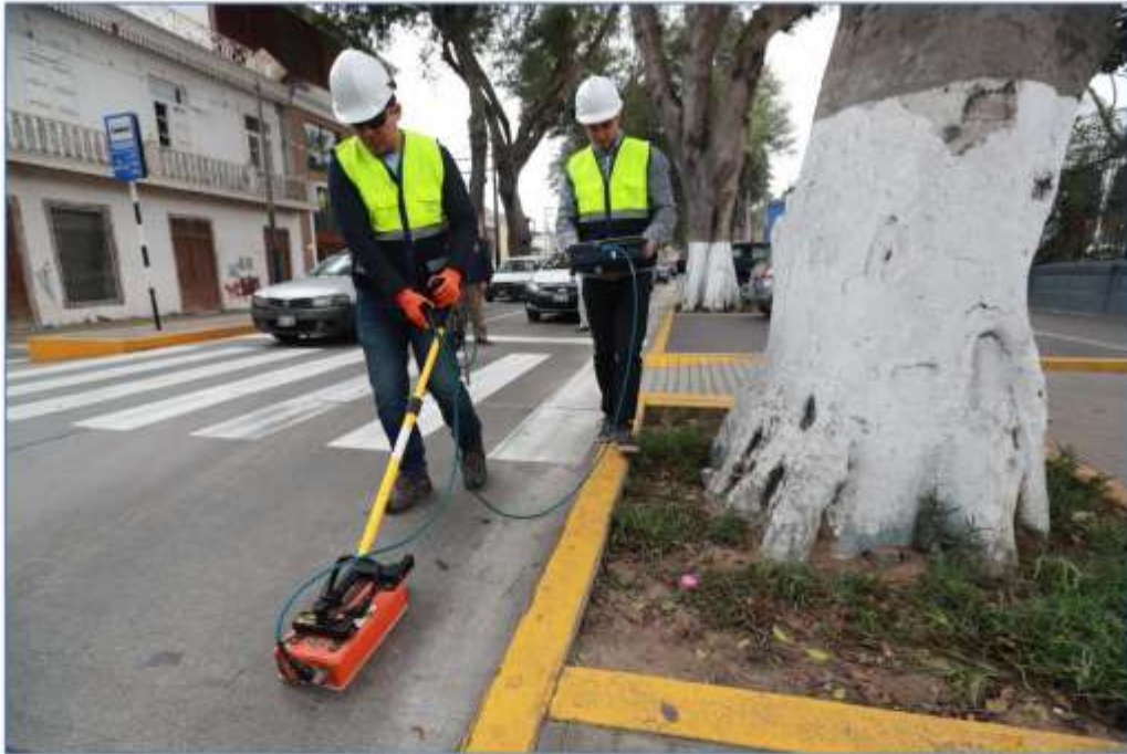
Imagen N° 10. Escaneo paralelo de raíces según tipo de superficie.
